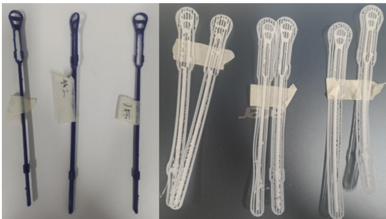
Kuva 10 Kaupallisesta filamentista tulostetut nielunäytepuikot (sininen) ja itse valmistetusta filamentista tulostetut nielunäytepuikot (valkoinen).
