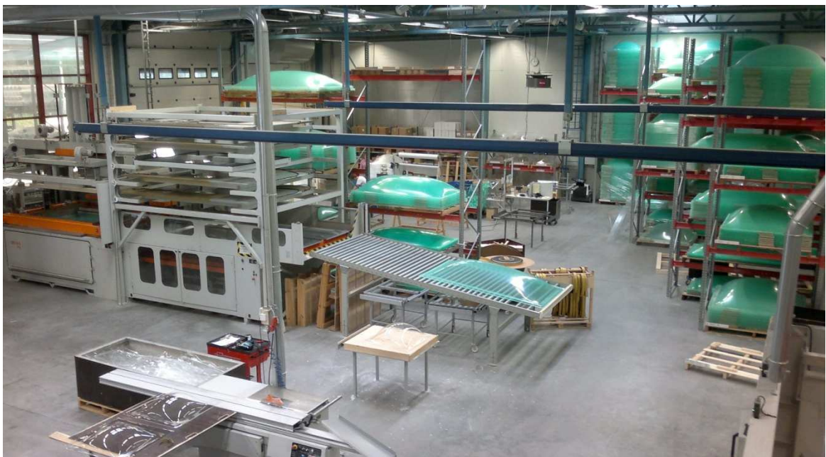
KUVA 3. Kattovalokupuosaston tuotantotilaa vuonna 2013. Keskellä Geiss-koneisto, jonka takana sijaitsee kattokupujen yhdistys- ja pakkauspisteet. Oikealla on kupujen kuorivarasto.
