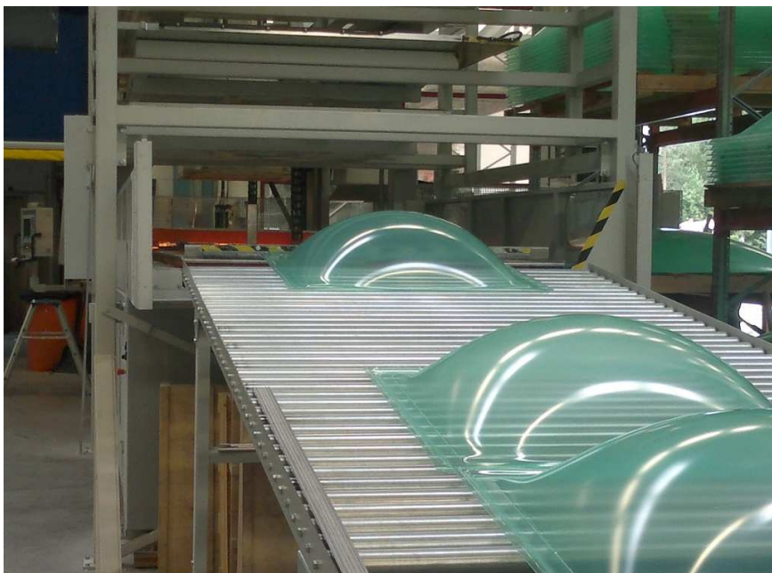
KUVA 10. K-1000x1000-kuputyypin välikuoria valmistumassa Geiss-tuotantolinjalta
