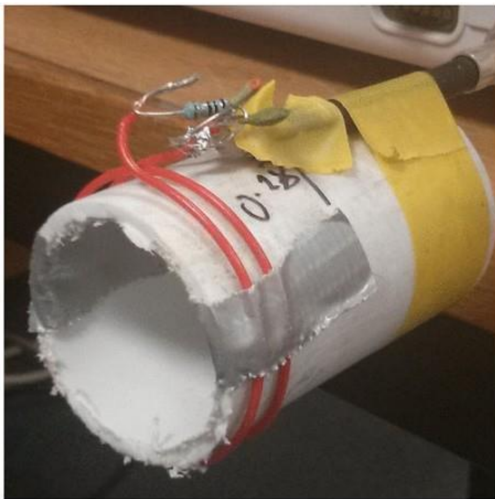
Kuvio 29. Surreyn yliopiston tutkimusryhmän laitteistossa käytetty kela-antenni (Diakos, Briffa, Brown & Wesemeyer 2013)
