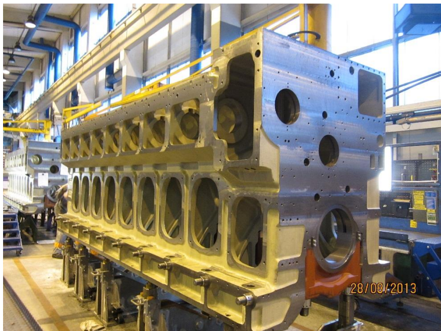
Kuva 13. Tarkastuspaikalla oleva rivikoneen lohko, (Siirilä 8/13)
