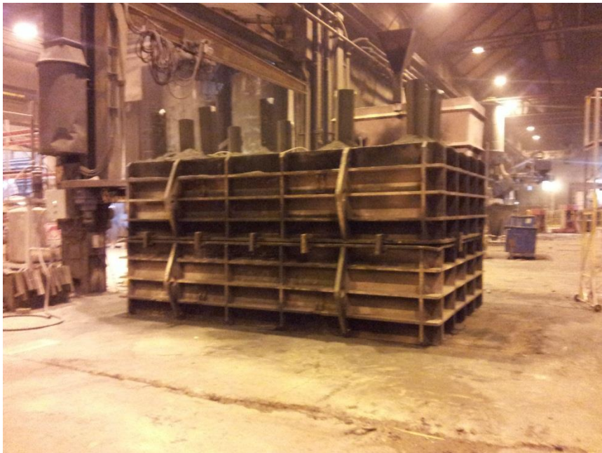
Kuva 12, kokoonpantu muotti valimolla (Siirilä 2/15)
