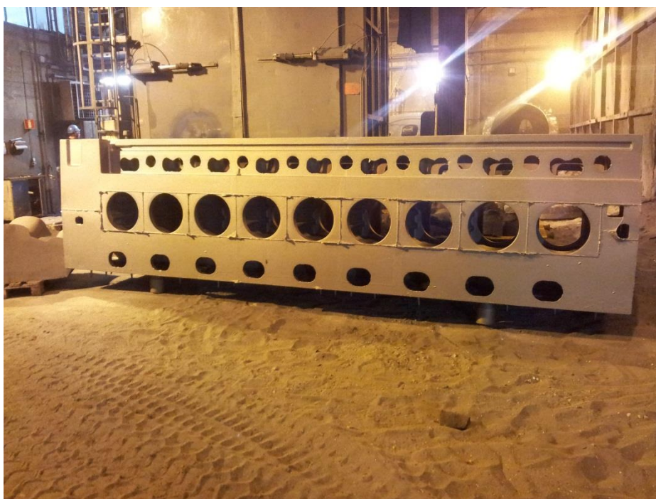
Kuva 8. Muotista purettu ja jälkikäsitelyä odottava lohko. Karlstadin valimo (Siirilä 2/15)
