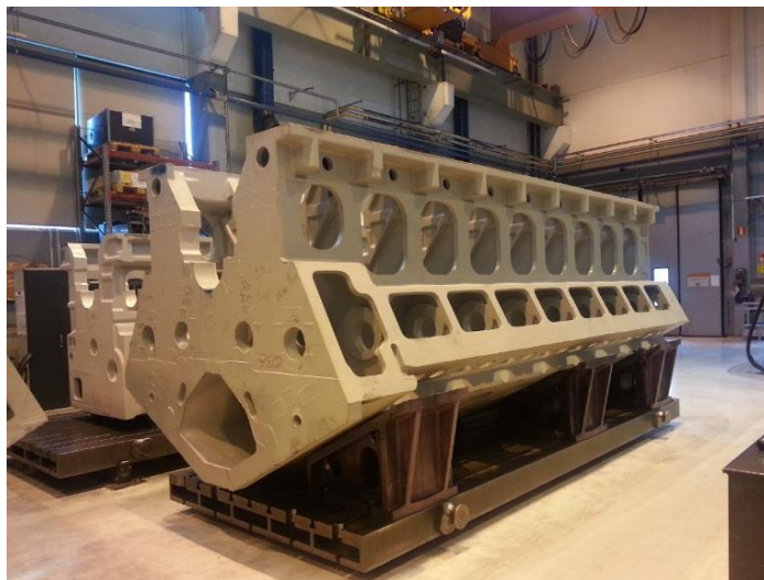
Kuva 11, V-koneen lohko piirrotuspaikalla (Siirilä 3/15)
