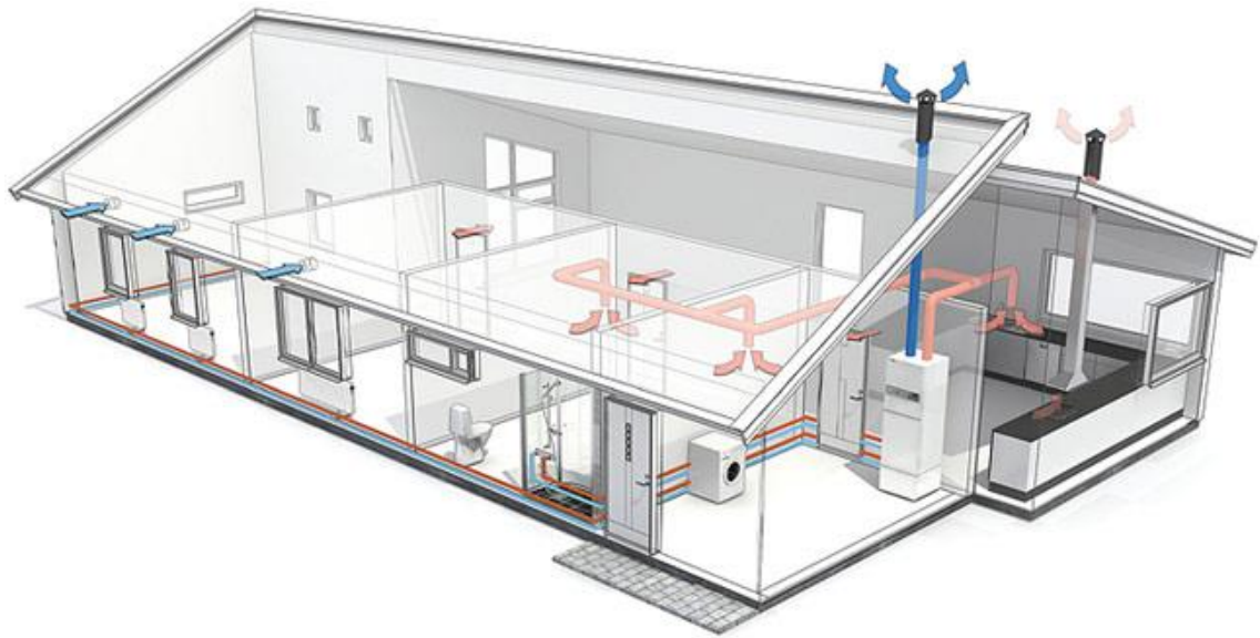
Kuva 2. Niben poistoilmalämpöpumpun toimintaperiaate [6].
