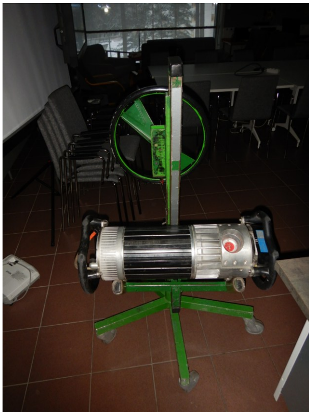
Kuva 6. Perinteinen teollisuusröntgenputki säädettävässä kuvaustelineessä ja ohjauspöytä.
