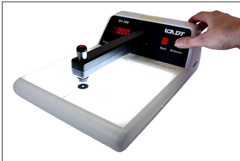
Kuva 13. Esimerkkikuva mustumamittarista eli densitometrissä (ndttukku.fi www-sivu).
