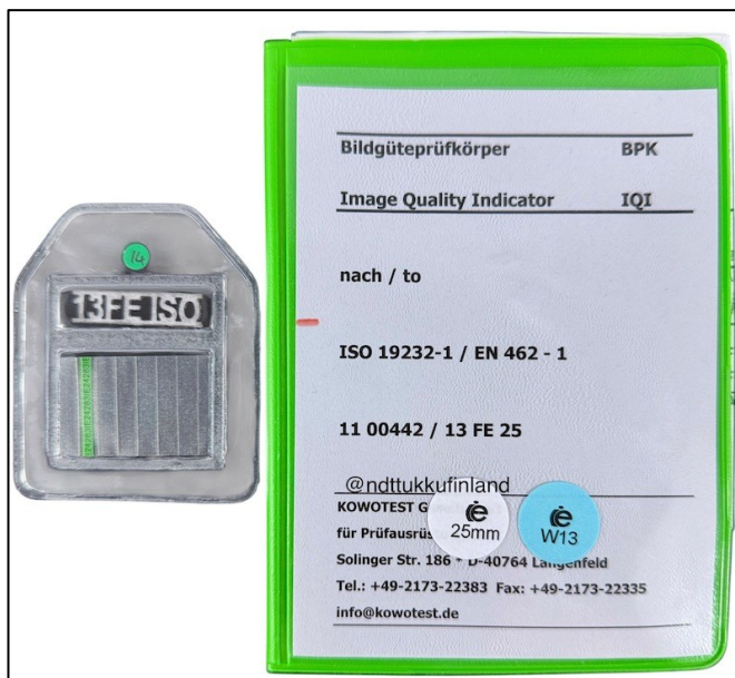
Kuva 11. Yleiskuva indikaattorilangoista. Lankoja on eri materiaaleja, kuvattavan putken materiaalin mukaisesti (ndttukku.fi www-sivu).
