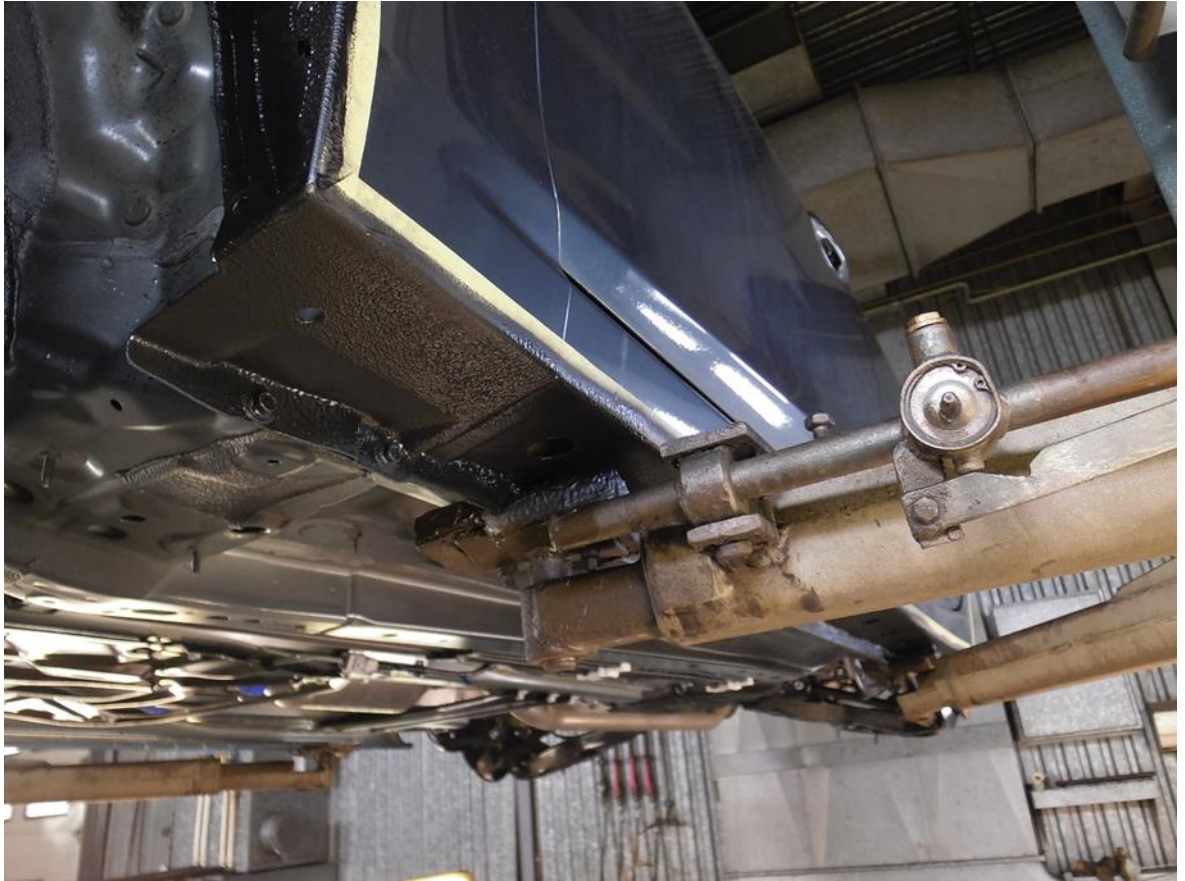
Kuva 24. Kiveniskusuojattu helmapelti Kiveniskusuoja-aine muodostaa kiveniskemiä ym. kulutusta kestävän pinnan.
