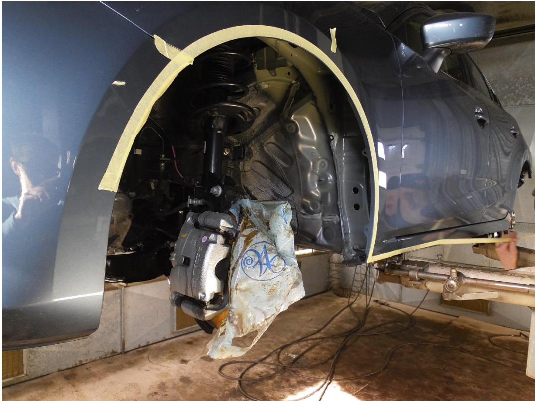
Kuva 17. Suojaus Suojuksessa peitetään tai rajataan alueet, joihin suoja-aineita ei haluta levittää.
