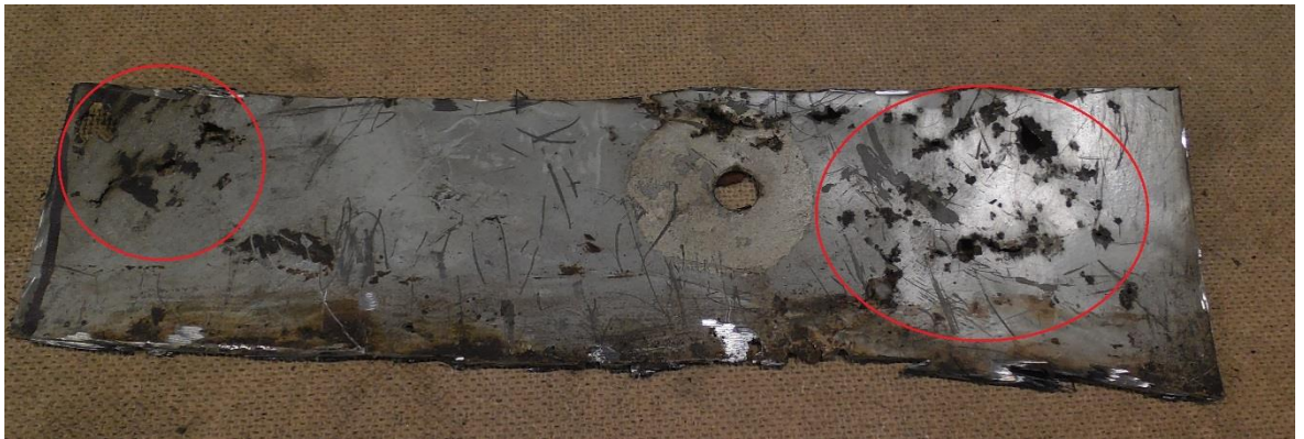
Kuva 3. Pistekorrosio ajoneuvon pohjapellissä Alla olevaan kotelorakenteeseen kerääntynyt lika ja kosteus ovat aiheuttaneet pistemäistä läpiruostumista.
