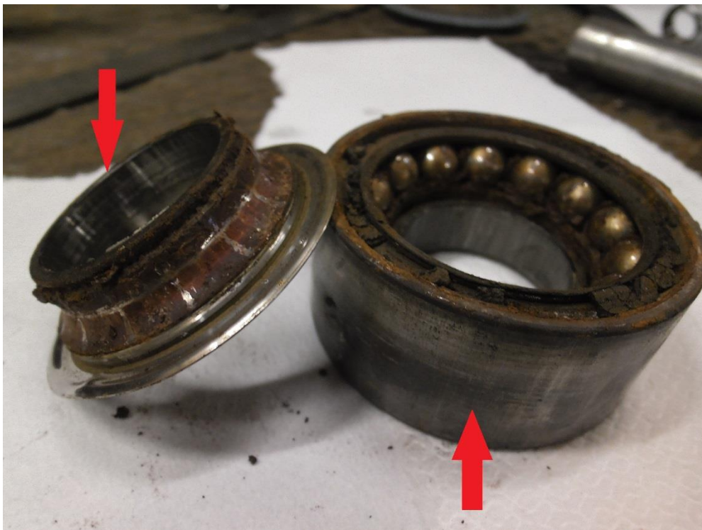
Kuva 6. Hiertymiskorroosiota laakerissa Kuluneen pyöränlaakerin kontaktipinnoilla voidaan hiertymiskorroosio havaita mustina alueina.
