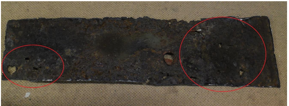
Kuva 4. Pohjapellin kääntöpuoli kuvasta 3 Yleistä korroosiota sekä pistemäistä läpiruostumista.
