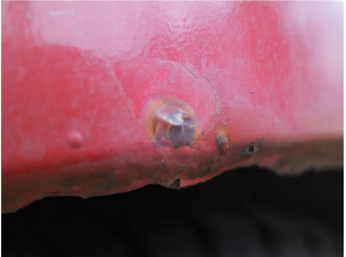
Kuva 11. Pistekorrosio lokasuojassa, lähikuva Ajoneuvoissa ruostuminen usein seurausta kiveniskemistä. Kuvassa on lähiotos lokasuojan ruostevauriosta.
