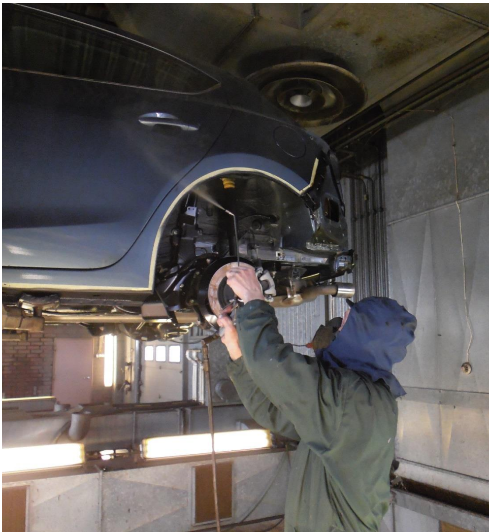
Kuva 18. Koteloaineen ruiskutus Kotelonsuoja-aine levitetään auton koteloihin sekä alustaan korroosion estämiseksi ja pysäyttämiseksi.
