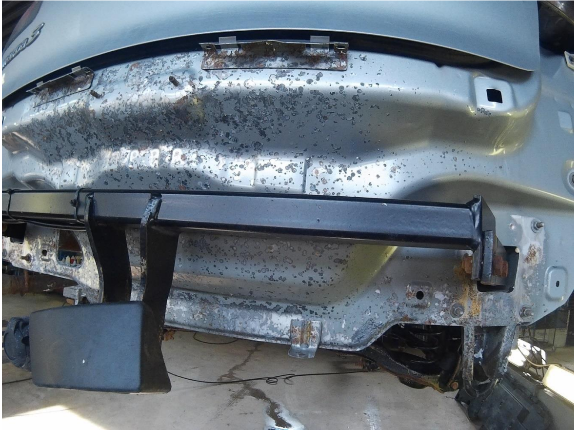
Kuva 5. Pistemäistä syöpymärakkulaa ajoneuvon takaosassa Sinkin syöpyminen havaitaan helposti tummina pyöreäköinä laikkuina. Pahimmissa syöpymäkohdissa on havaittavissa jo ruostetta
