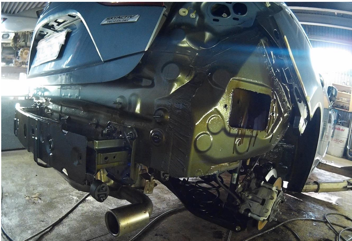
Kuva 19. Koteloainekäsittely Sekä kotelot että alusta on käsitelty kotelosuoja-aineella.
