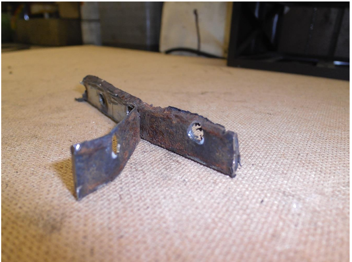
Kuva 2. Rakokorroosio Auton kaksi pohjapeltiä ovat ruostuneet pistehitsauksien välistä.
