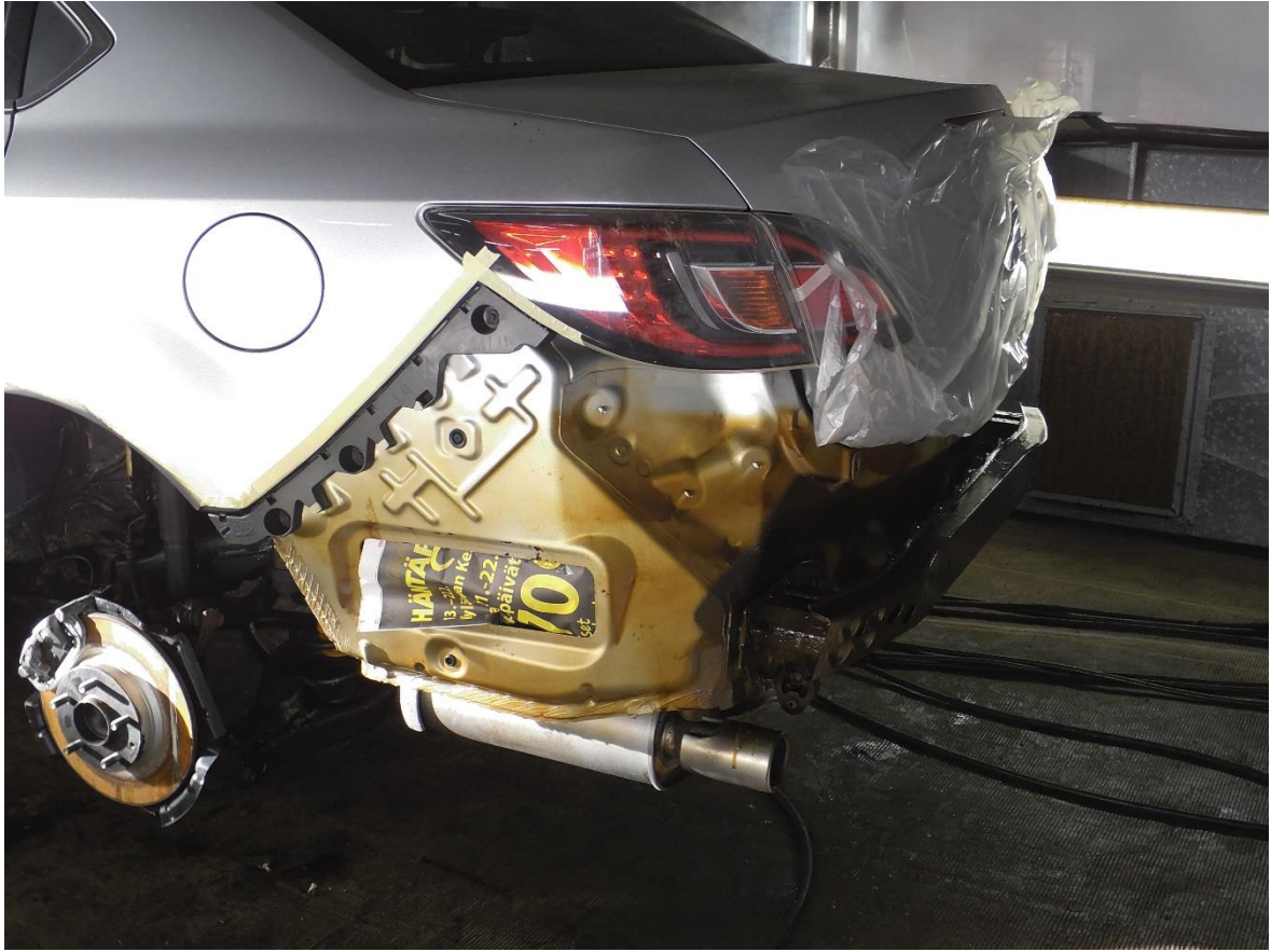
Kuva 21. Ennen alusta-ainetta Auton takaosa ennen alustansuoja-aineen ruiskuttamista.
