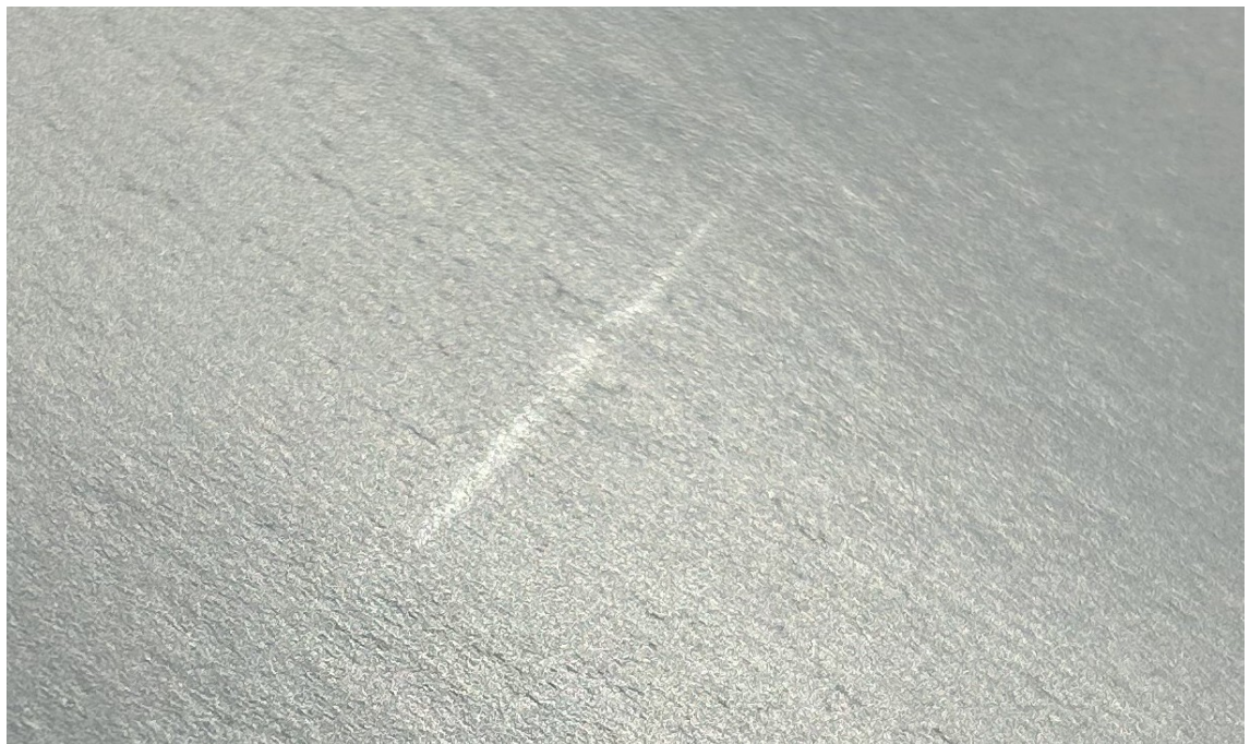
KUVA 7. Syväpainolakkauksen vika (Kuva: Kalle Koljonen).
