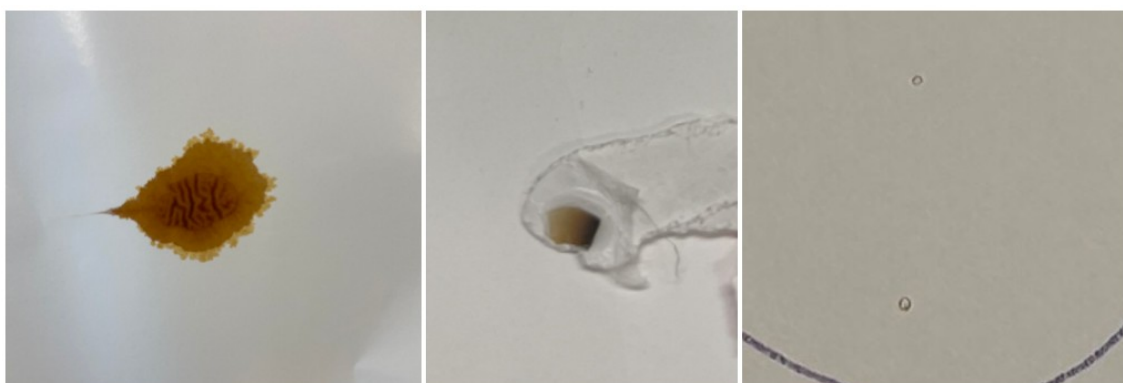
KUVA 13. Vasemmalla öljytahra, keskellä palanut muovipartikkeli, oikealla pintäkäsittelystä aiheutunut jälki (Kuva: Walki).
