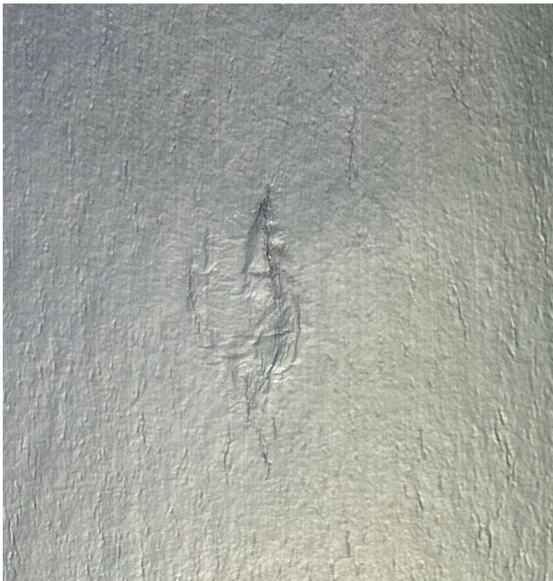
KUVA 9. Häiriö liimalaminoinnissa on havaittavissa liimaa imemättömän materi- aalin pinnasta (Kuva: Kalle Koljonen).
