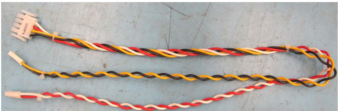
Kuva 5. Kierretystä kaapelista valmistettu johdinsarja
