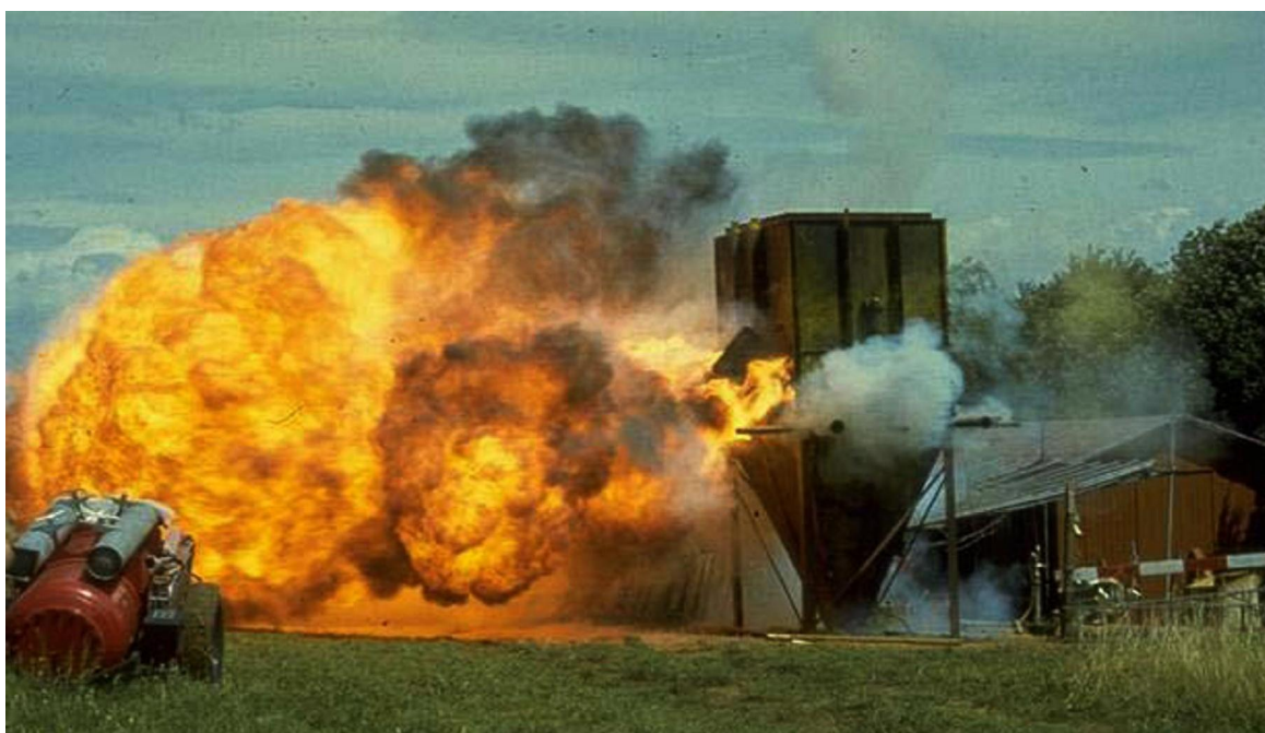
Kuva 1: Siilon pölyräjähdys (Dustec Oy Markku Juntunen)
