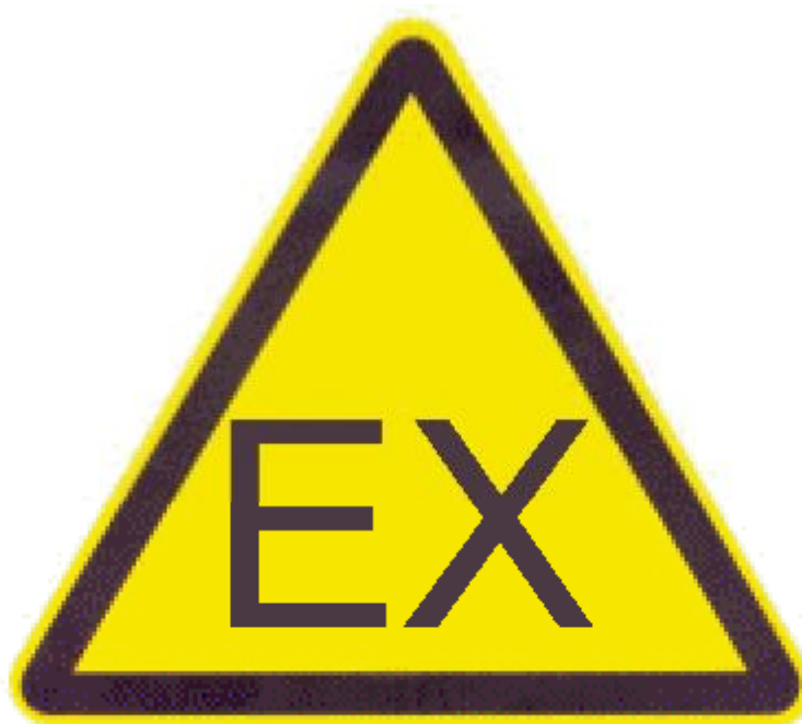
Kuva 5: Kolmion muotoinen varoitusmerkki (ATEX-olosuhdeasetus, liite 3) Merkki on kolmion muotoinen ja siinä on mustat kirjaimet, keltainen tausta ja musta reunus. Keltaisen osuuden on peitettävä ainakin 50% merkin alasta.
