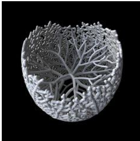
Kuva 4. 3D-tulostettu ontto ja huokoinen kappale (Nervous Systems 2014)
