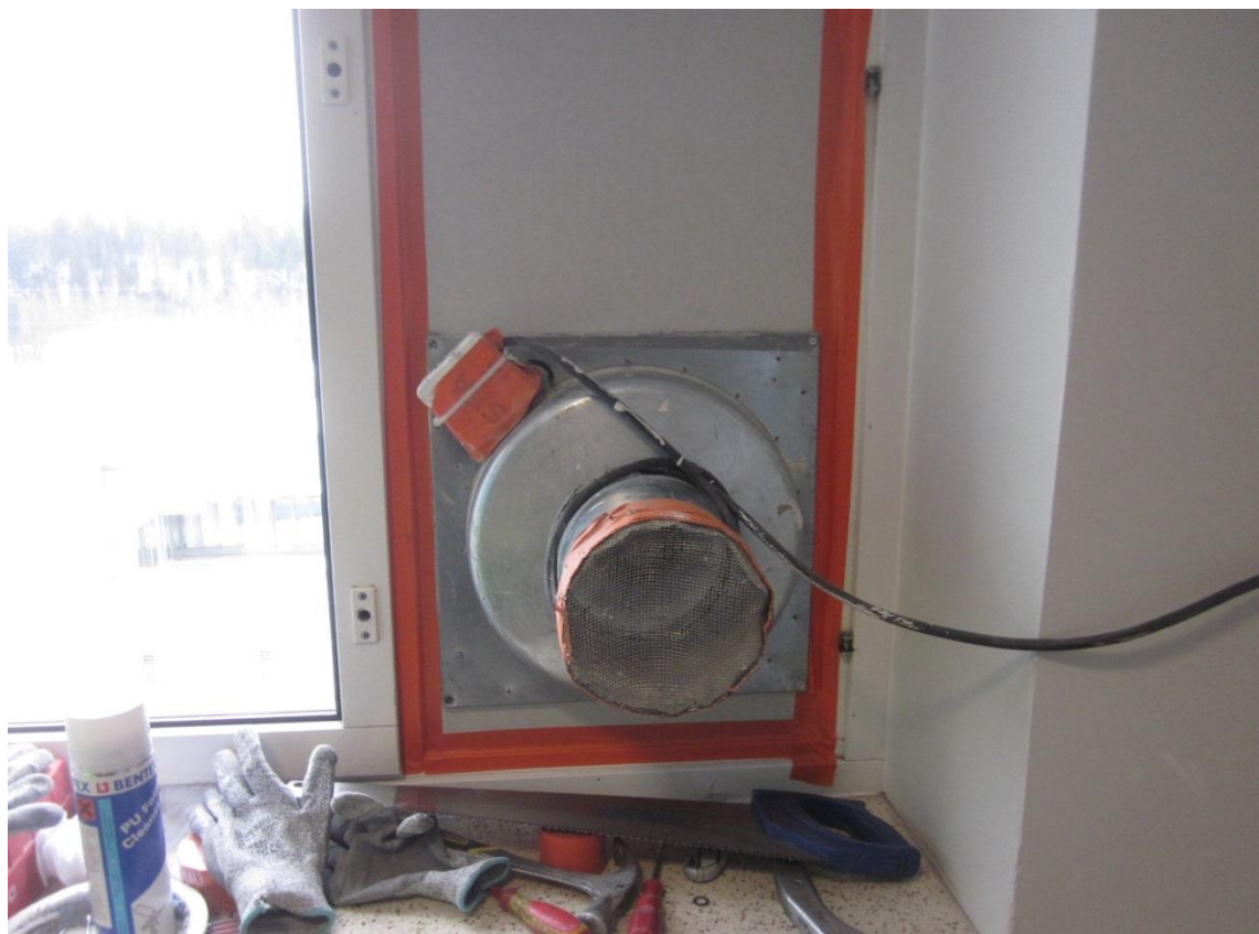
Kuva 2. Alipaineistajan oikeaoppinen asennus ikkuna-aukkoon. Kuva Kylliäinen, Juho.
