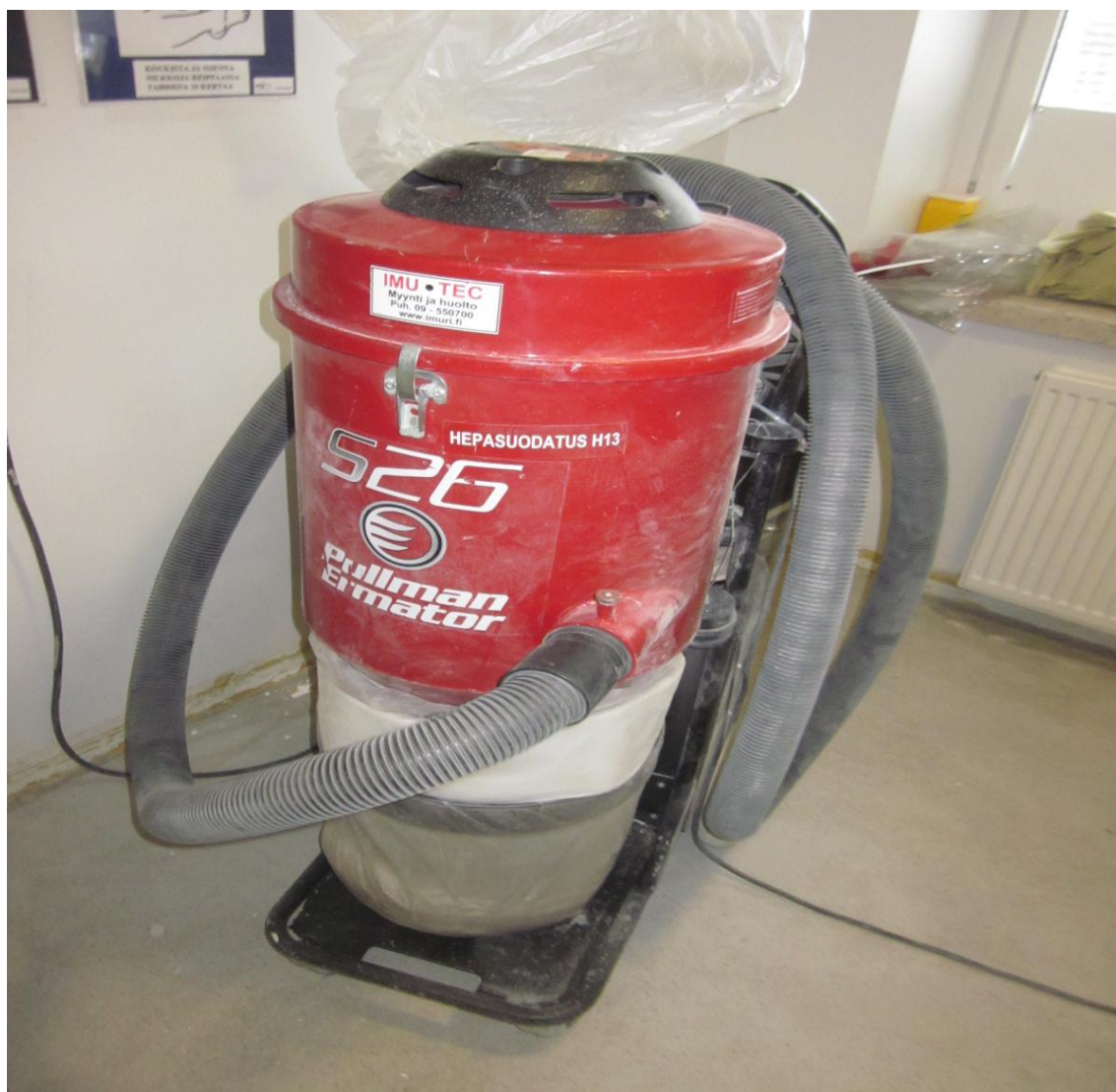
Kuva 4. HEPA-suodattimella varustettu rakennuspölynimuri. Kuva Kylliäinen, Juho.
