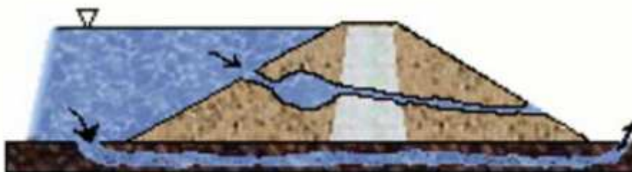
KUVA 4. Vuotokanava patorakenteessa tai pohjamaassa (10, s. 11)
