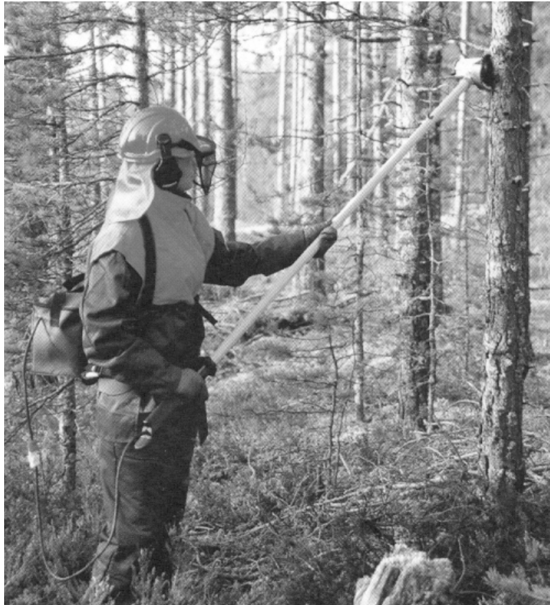
Kuva 24 Teko-sahan terä pyörii sähkövirran voimalla. (Kuva: Teko-moottorisaha pystykarsintaan 1998)
