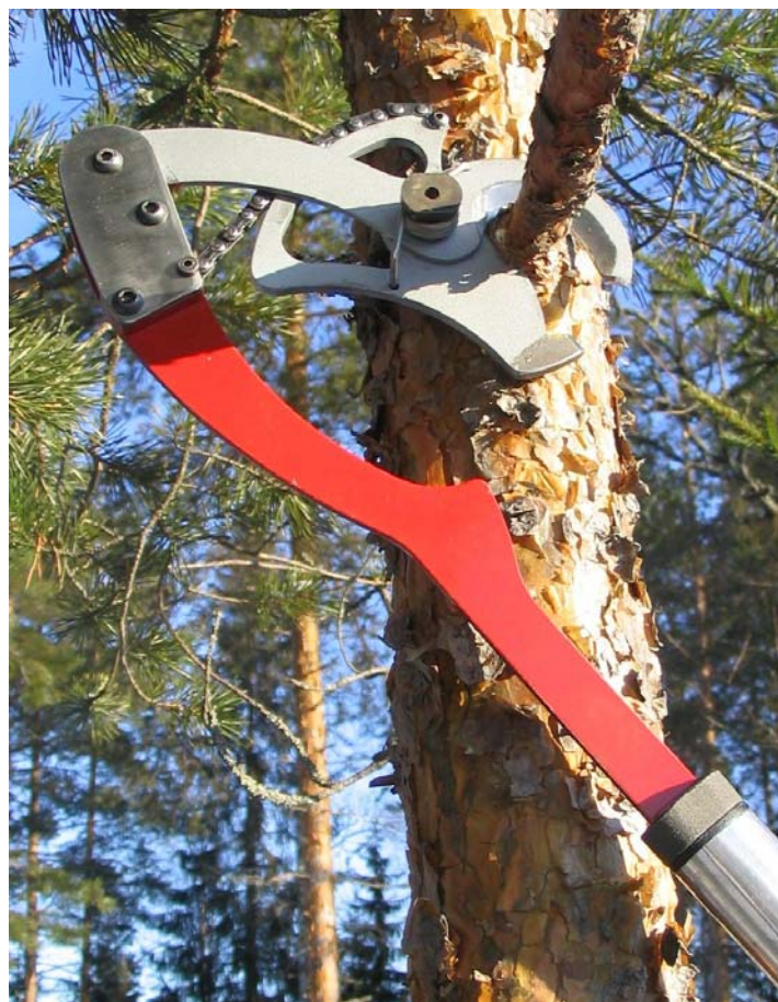
Kuva 23 Falco Karsija 30:n terät katkaisevat oksan, kun varresta vedetään alaspäin. (Kuva: Eero Pikkarainen)
