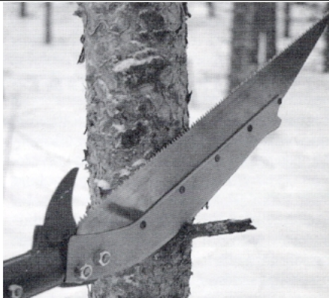
Kuva 18 Kuolleiden oksien karsintaan käytetään veitsiosaa. (Kuva: Mutikainen ja Jouhiaho 2004)
