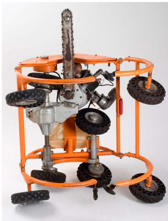
Kuva 27 Tree monkey -pystykarsintalaite on kiivennyt puuhun kumipyörien avulla. (Kuva: Lusto/Timo Kilpeläinen)
