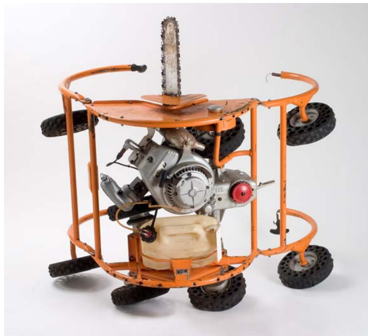
Kuva 28 Tree Monkeyn polttoainetankki ja moottori ovat laitteen takapuolella. (Kuva: Lusto/Timo Kilpeläinen)
