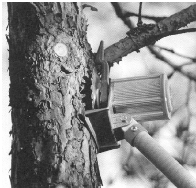
Kuva 25 Teko-sahan pyöröterä, teräohjain ja sähkömoottori. (Kuva: Teko-moottorisaha pystykarsintaan 1998)
