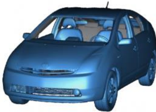
Figur 3. CAD modell på en 3D scannad bil
