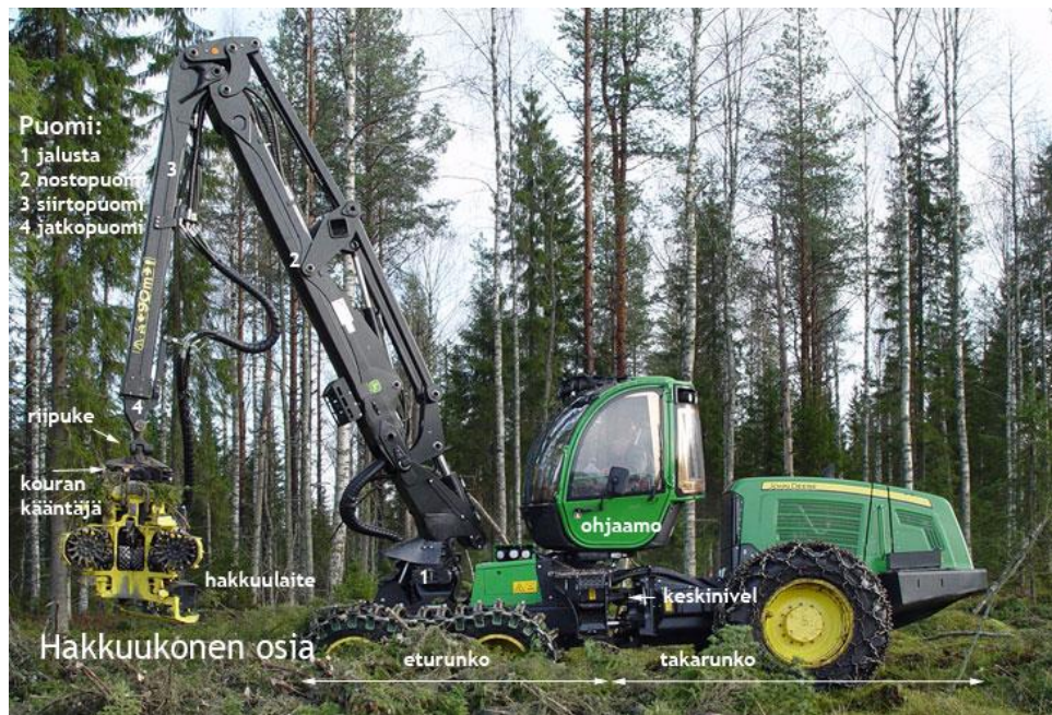
Kuva 1. Hakkuukoneen osia. Kuva: Kokkarinen 2012, 43.
