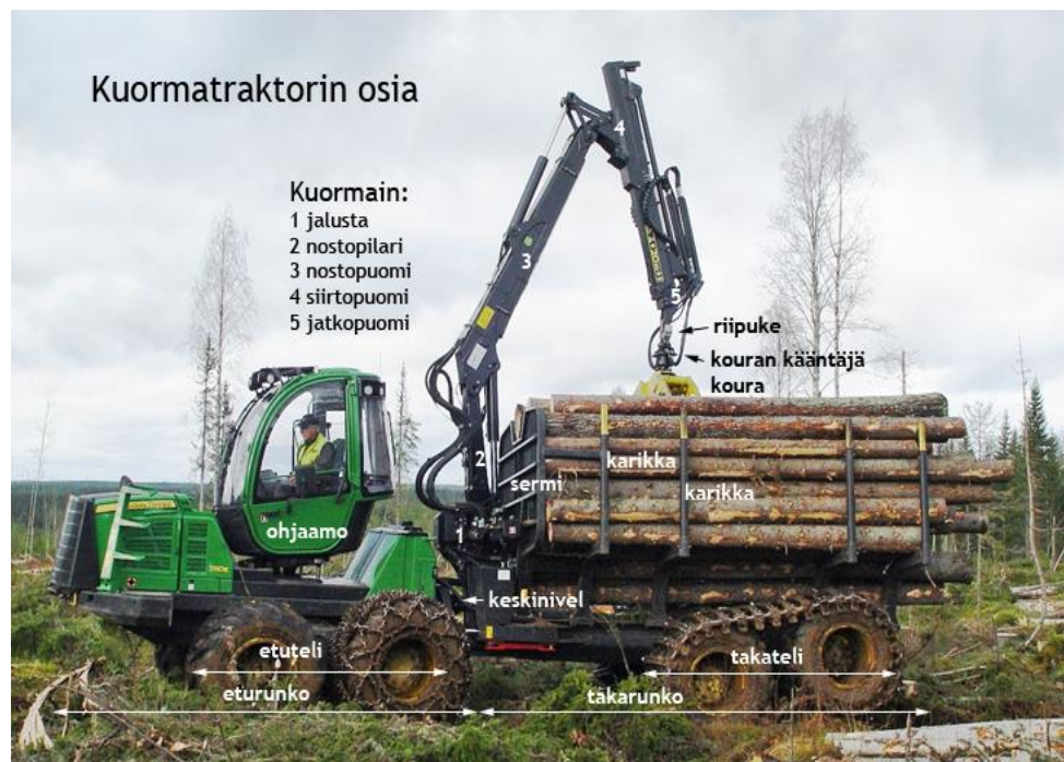
Kuva 3. Ajokoneen osia. Kuva: Kokkarinen 2012, 10.
