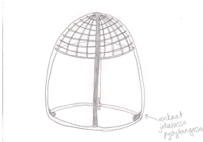
Kuva 6. Mustekalan vartalon tukirakenne.
