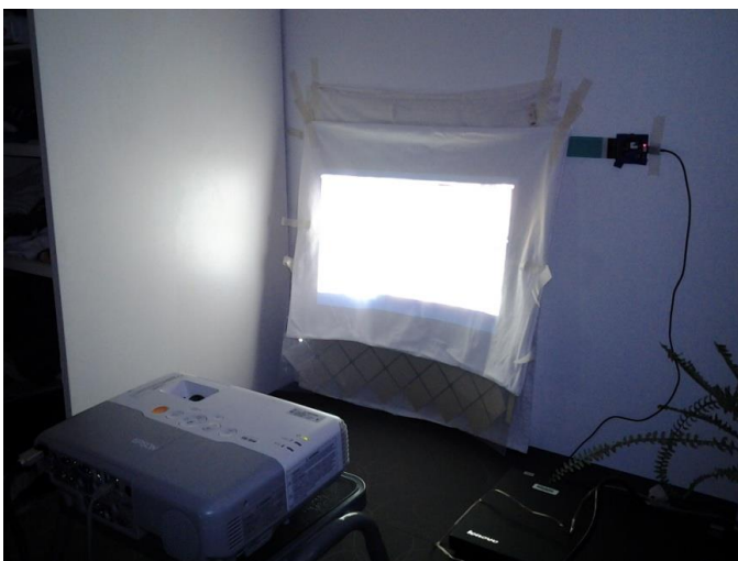
KUVIO 6. Projektorin, sensorikalvon ja valkokankaan testiasettelu
