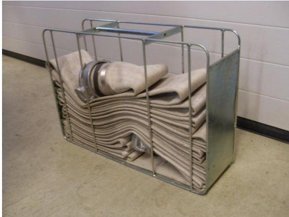
Kuva 6. 20 metrin mittainen 110 mm paloletku alumiinisessa letkukehikossa.
