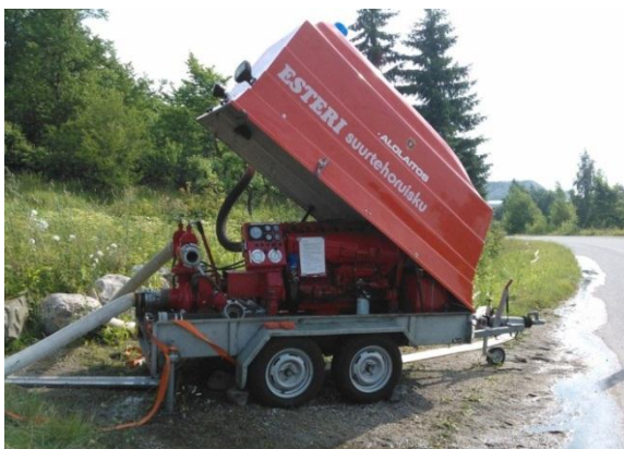
Kuva 2. Esteri 4000 –suurtehoruisku toimimassa paineenkorotuspumpuna.
