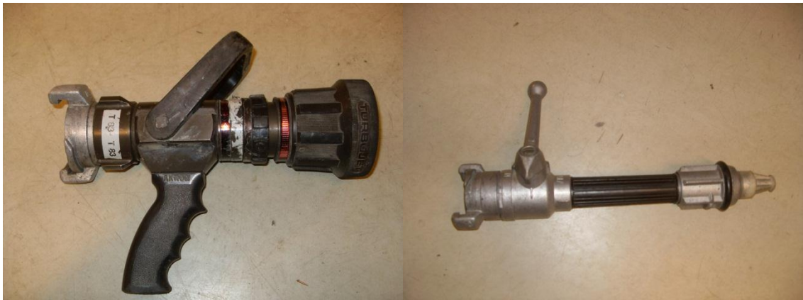
Kuvat 8 ja 9. Vasemmalla huoneistopalosuihkuputki ja oikealla suoratai sumusuihkuputki.
