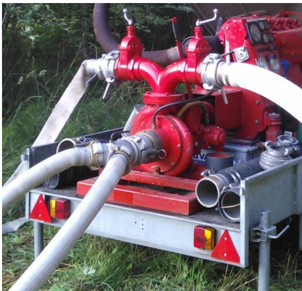
Kuva 15. Kaksi 76 mm paloletkua syöttää sammutusvettä pumppuun BB/A-haaraliittimen kautta.
