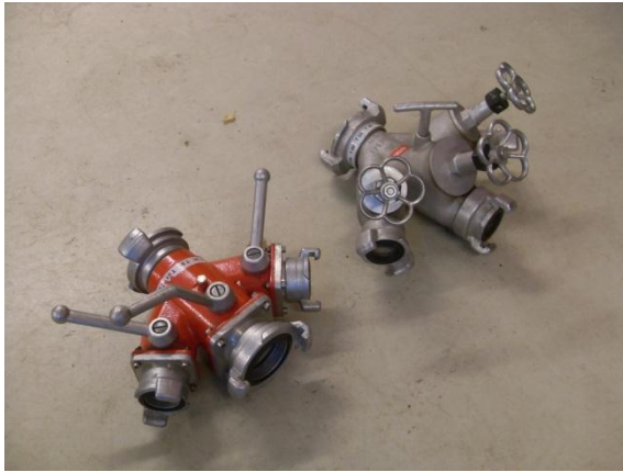
Kuva 11. Vasemmalla B/CBC-jakoliitin palloventtiileillä ja oikealla B/CCC-jakoliitin kierreventtiileillä.
