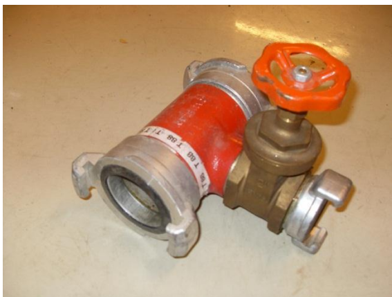
Kuva 12. Oksaliitin B-B/C varustettuna luistiventtiilillä.
