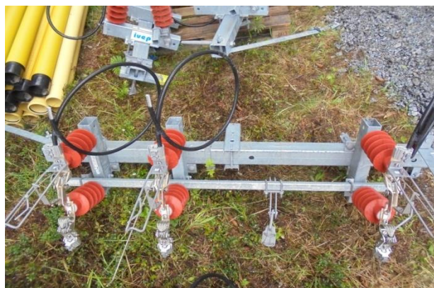
KUVA 11. Käsikäyttöinen linjaerotin, jossa on katkaisupiiskat (Toivanen 2014-6-20.)
