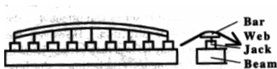
Kuva 4 Levitysrauta sivusta. Kuvassa näkyy myös säätötukki. /7/
