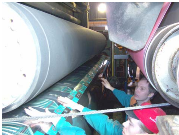
Kuva 17. Metson miehet T. Kuninkaanniemi ja O. Heiskanen asentamassa paineantureita Expandanippiin.
