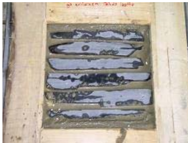
Kuva 10. Sementtiä läpäisemätön tekstiilinylonverkko
