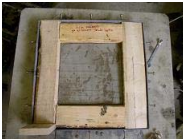
Kuva 8. Sementtimassan päällä tekstiilinylonverkko
