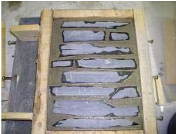
Kuva 28. liuskeet asennettu laattaan
