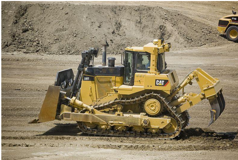
Kuva 13 Puskutraktori PT varustettuna monipiikkisellä repijällä, Cat
