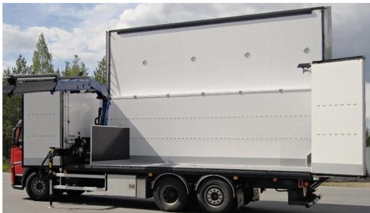
Kuvio 7. Liukuovilla ja aukeavalla katolla oleva ratkaisu. (Kuvagalleria Toplift Finland Oy:n referensseistä. 2015)
