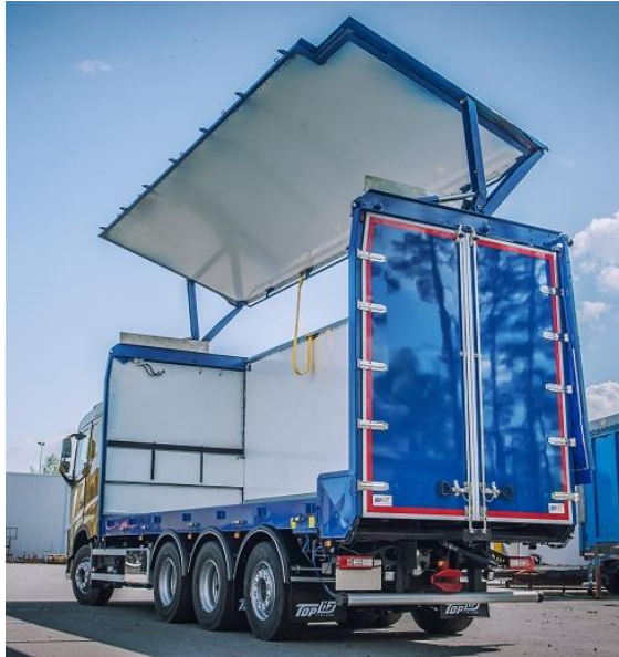
Kuvio 6. Nousevalla seinällä oleva päällirakenne. (Kuvagalleria Toplift Finland Oy:n referensseistä. 2015)
