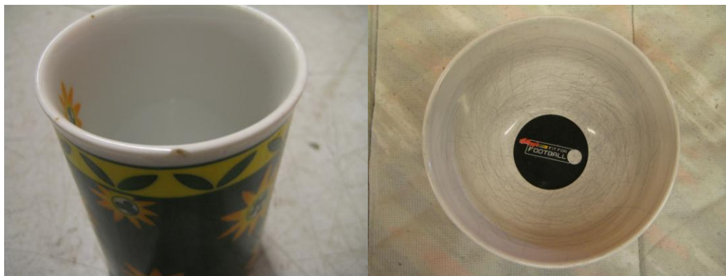
Kuvio 7. Kuppiin tullut lohkeama (vasemmalla) ja kupissa hankausjälkiä (oikealla).
