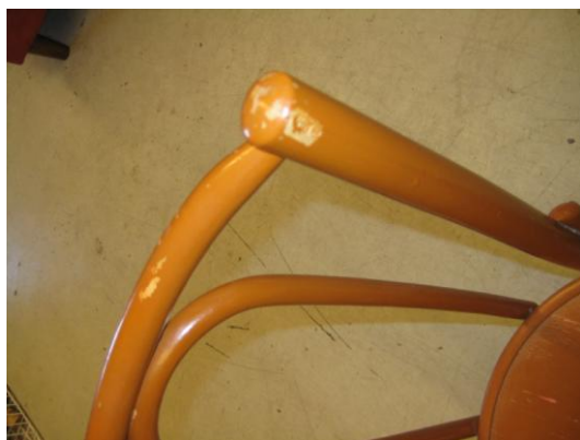
Kuvio 4. Maalipinta vähäisesti vaurioitunut.
