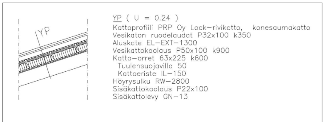
Kuva 3 Kattorakenne
