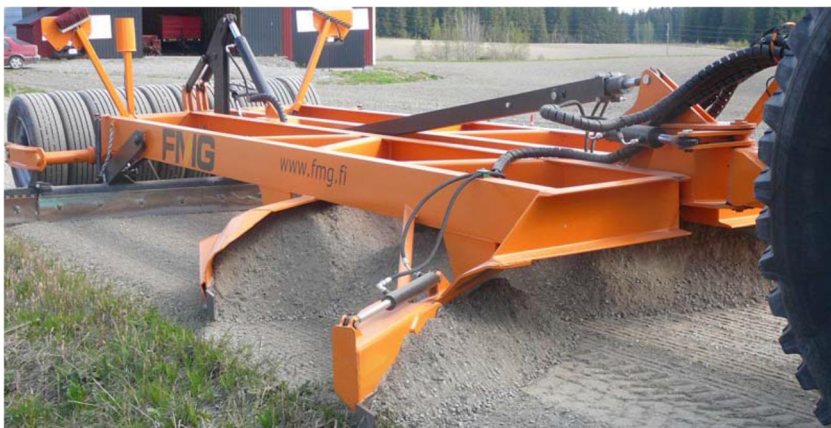
Kuva 10. Muokkaus traktorin perään kiinnitettävällä lanalla. (Liikennevirasto sorateiden kunnossapito LO 1/2014, 40)
