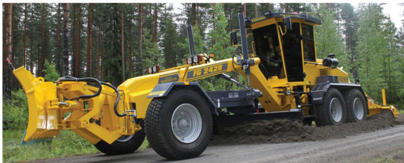
Kuva 6. Muokkaushöyläys. (Liikennevirasto sorateiden kunnossapito LO 1/2014, 39)
