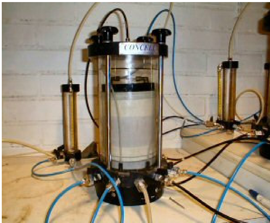
Kuva 7. Pehmeäseinäinen vedenläpäisevyyttäytymis- laitteisto
