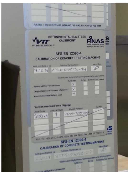
Kuva 9: VTT Expert Service Oy:n tarkastuskilpi.
