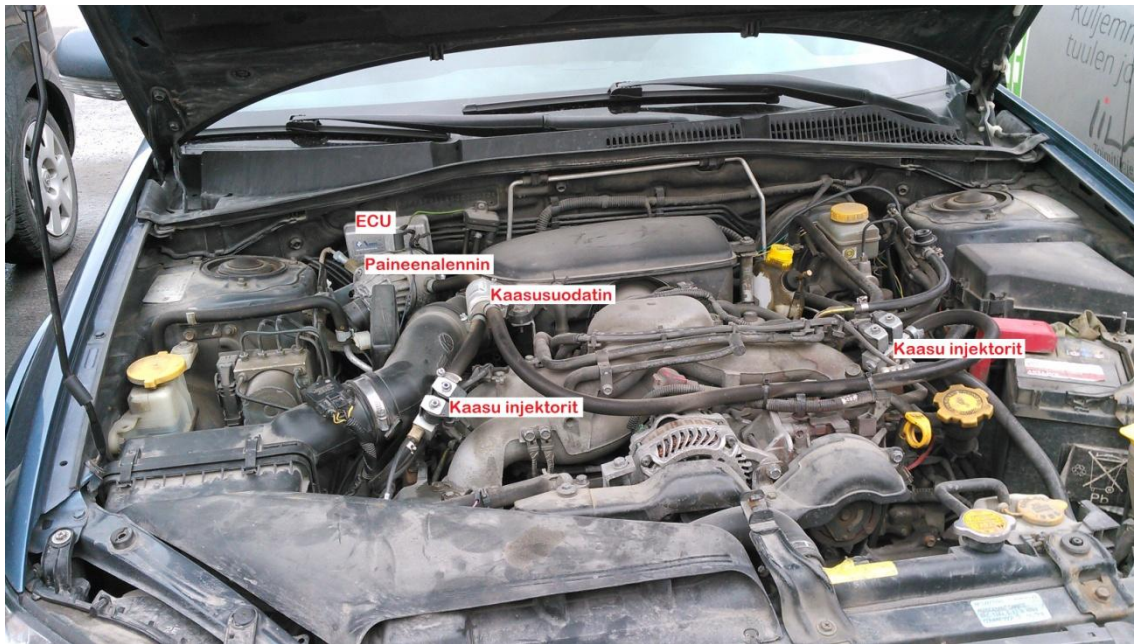
KUVA 11. Subaru henkilöauton kaasukonversion osat ottomoottorissa
