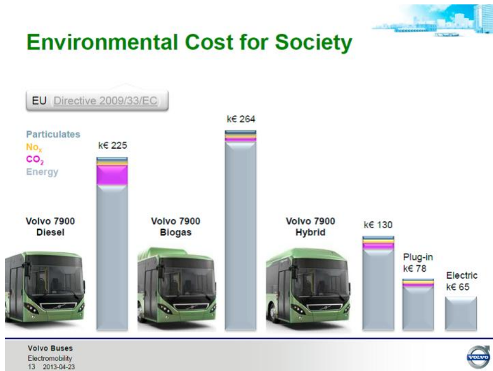
KUVA 16. Käyttövoimavaihtoehtojen ympäristökustannuksia busseissa (Korte. 2013)
