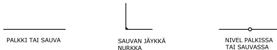
Kuva 3.2.1 Rakennemallien osia ja merkintöjä.
