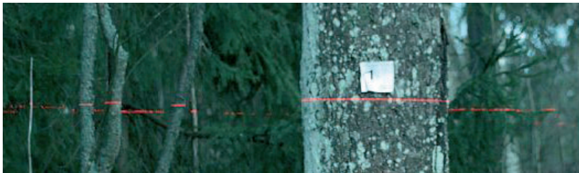
KUVA 11. Järjestelmäkameraan integroidun laserin käyttöä on tutkittu läpimitan etämittauksessa - (kuva Timo Melkas)
