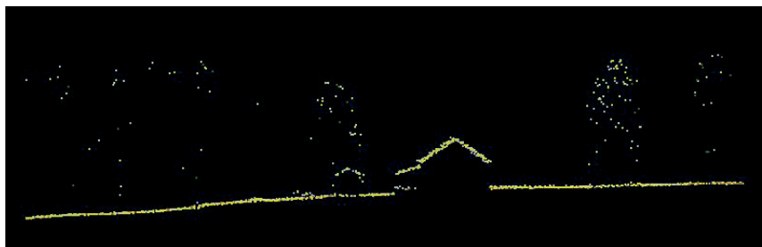
KUVA 15. Rakennukset ja pihapuut erottuvat pistepilven profilista (kuva Pertti Kilpeläinen)
