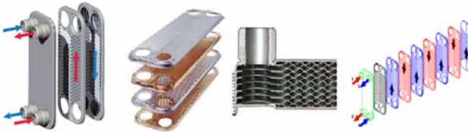
Kuva 43: Juotetun levylämmönsiirtimen periaate 20, 21
