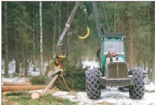
KUVA 2. Hakkuutähdekasoista tehdään riittävän suuria ja ainespuut hakataan omiin kasoihinsa (Kuva: pkky.fi a)
