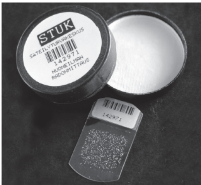
Kuva 7 Radonmittauspurkin sisällä on polykarbonaattikalvo /12, s. 136/
