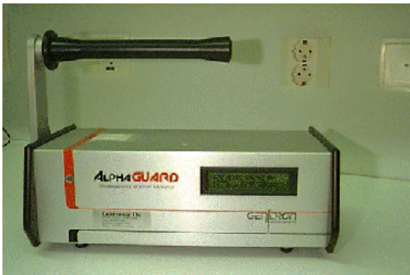
Kuva 8 Jatkuvasti rekisteröivä radonmittari /13, s. 34/
