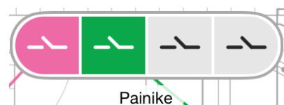
Kuva 38. PBC-yksikön symboli. PBC-yksikköön on mahdollista liittää neljä kytintä tai painiketta, joten siinä on neljä päätepiistettä. Vaaleanpunaisella ja vihreällä esitetyt päätepiisteet on käytössä ja liitetty valaistusryhmiin.
