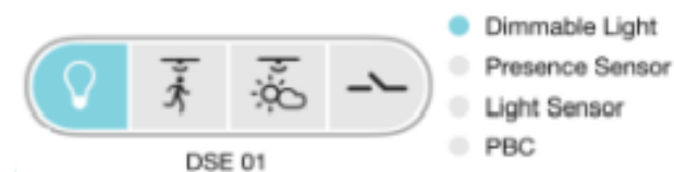
Kuva 37. DSE-yksikön symboli. Laitteessa on neljä päätepiistettä: valaisin, läsnäolosensori, päivänvalosensori ja kytin/painike.
