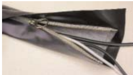
Kuva 2 Häiriöherkkien elektroniikkalaitteiden, herkkien tietokone- ja tietoliikennekaapeleiden halpa ja käytännöllinen EMI- ja EMP-suojaus vetoketjullisella suojapussilla. Suojusta saatavilla 2,5 – 15 cm:n halkaisijalla sekä jopa 15m:n pituisena. /4./
