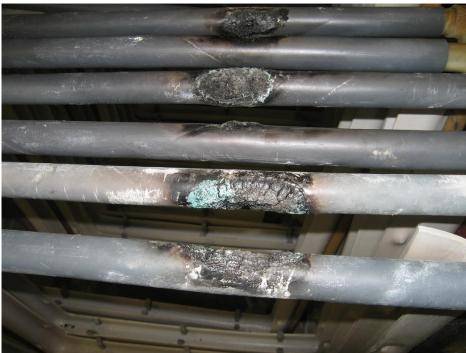
Kuva 3. Yläputken pinnoitteen palaminen oikosulussa.
