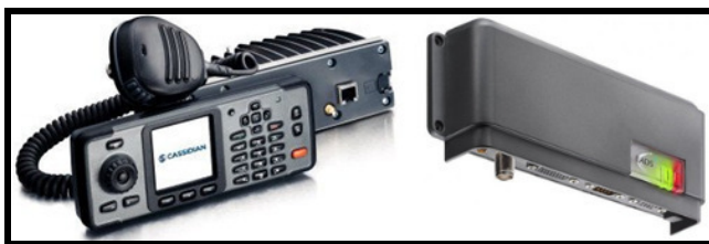
Kuva 13. Kuvassa vasemman puoleinen EADS TMR 880i ja oikean puoleinen EADS TDR 880i Virveradio (Virve Tuotteet ja Palvelut Oy.)
