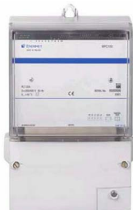
Kuva 30 Keskitin Enermet EMPC100-keskitin siirtää sanomia keskusaseman ja itsensä välillä joko GSM-, PSTN- tai LAN yhteyden kautta käyttämällä TCP/IP- ja PPP-yhteyshäntäntöä./19/
