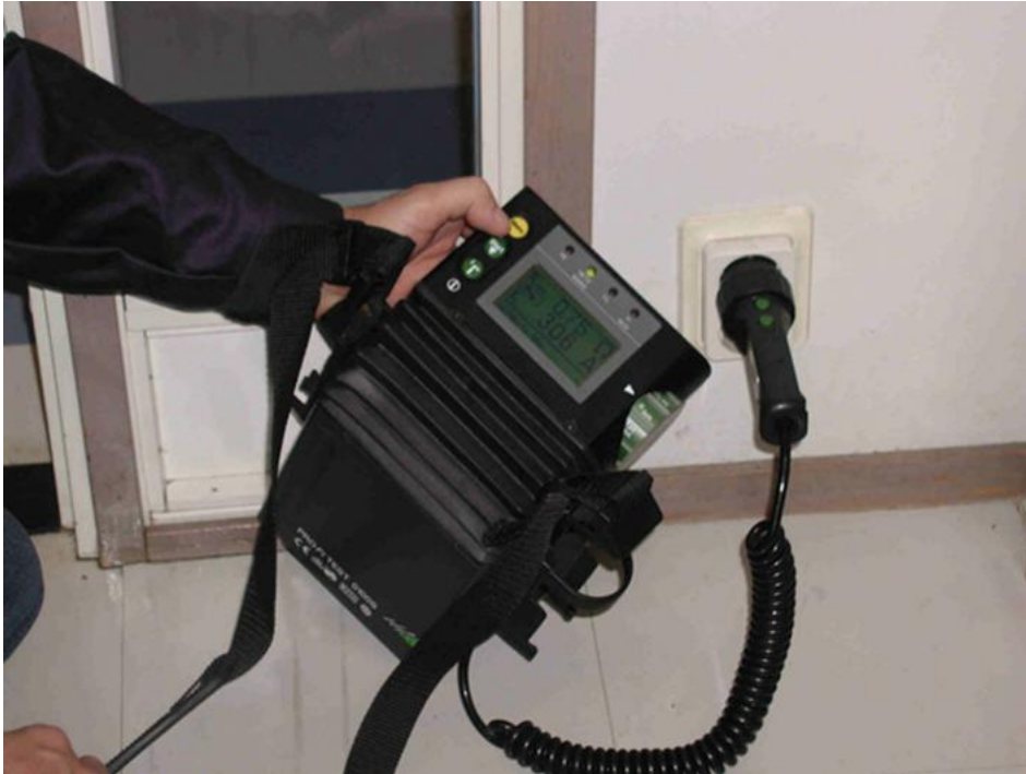
Kuva 12. Pienimmän oikosulkuvirran mittaaminen on helpointa tehdä pistorasiasta. /5/
