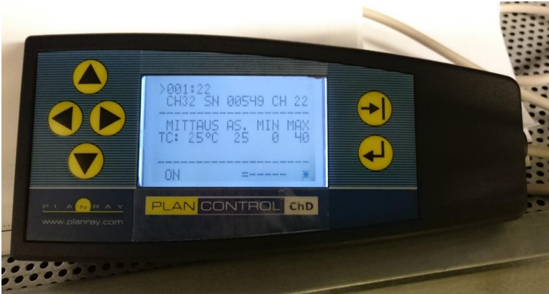
KUVA 14. ChD-käyttöliittymä. Perusnäkyssä voi tarkastella valitun lämpökaapelipiirin asetusarvoa ja lämpötilatietoa.
