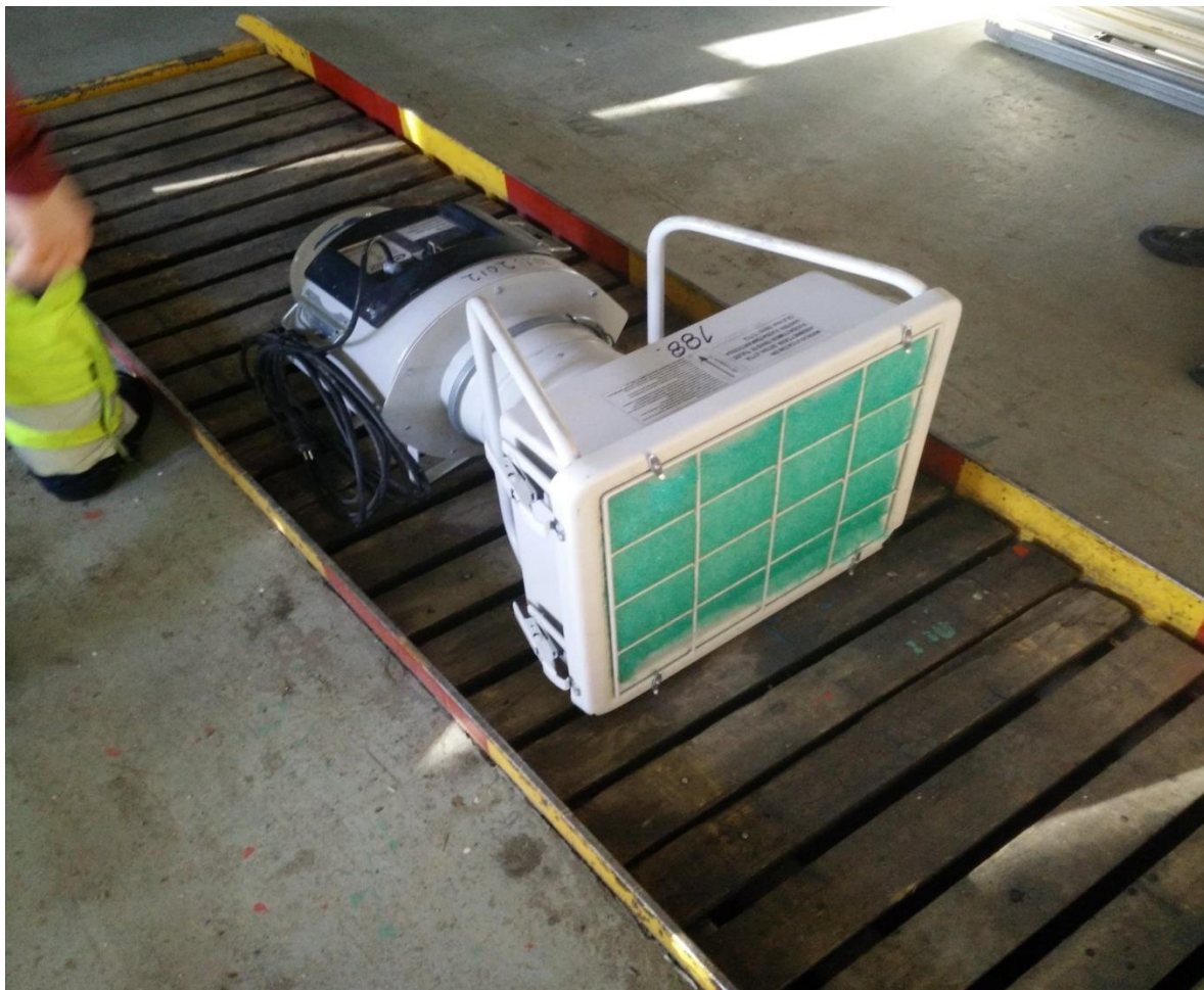
Kuva 2. Alipaineistaja, jolla voidaan johtaa ilma sisätiloihin (Udd Erik 2015)
