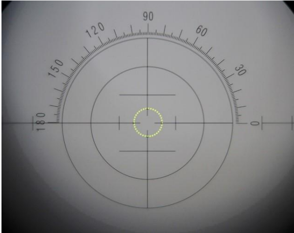
KUVIO 4. Näkymä valontaittomittarin sisältä, jossa testikuviona on pisteympyrä. (Emmi Laurila)
