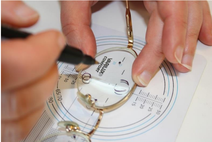
KUVIO 12. Merkintöjen piirtäminen moniteholinssiin asennuskaavion avulla. (Jonna Kostet)
