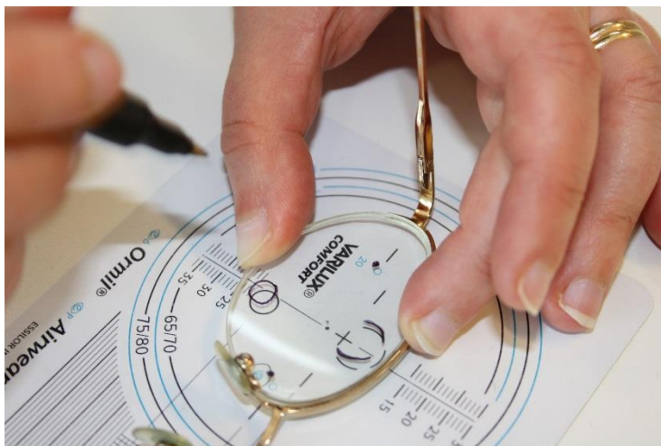
Kuva 13. Merkintöjen tekeminen linssiin asennuskaavion avulla.
