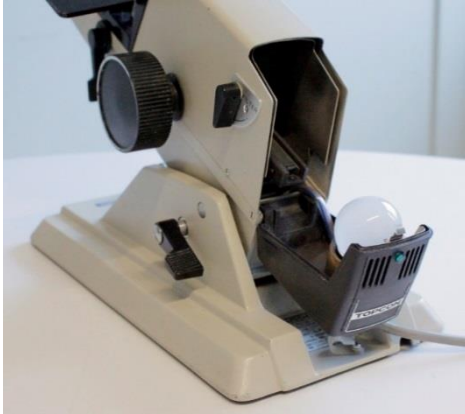
Kuva 20. Lampun vaihtaminen valontaittomittariin.
