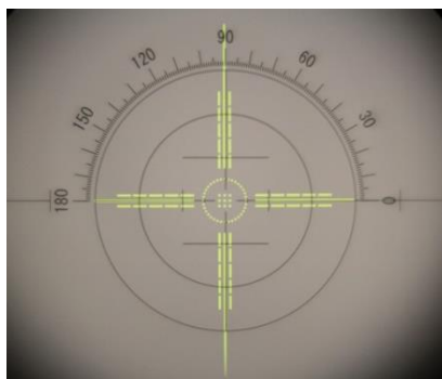
Kuva 16. Testikuvion keskipiste on linssin optisessa keskipisteessä.
