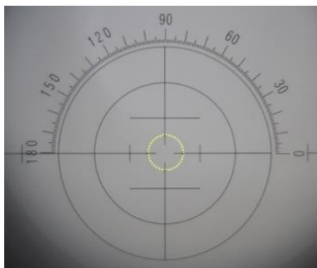
Kuva 10. Sfäärisen linssin testikuvio tarkentuu yhtäaikaaisesti ja tällöin linssin voimakkuus on luettavissa suoraan asteikolta.
