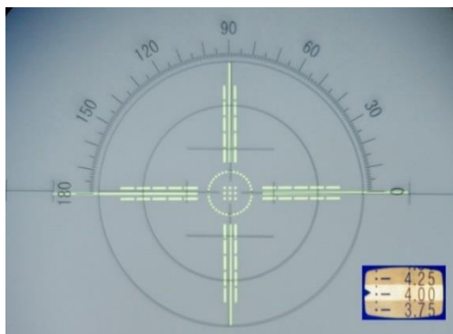
Kuva 7. Sfäärisen linssin kuvautuminen valontaittomittarissa.
