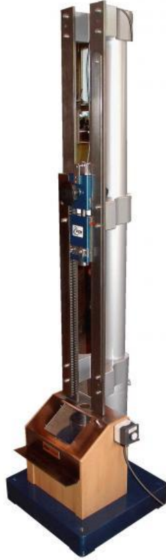
Kuva 7: BAM-pudotusvasarakoelaitte, jolla mitataan käsittelyturvallisuutta [10].
