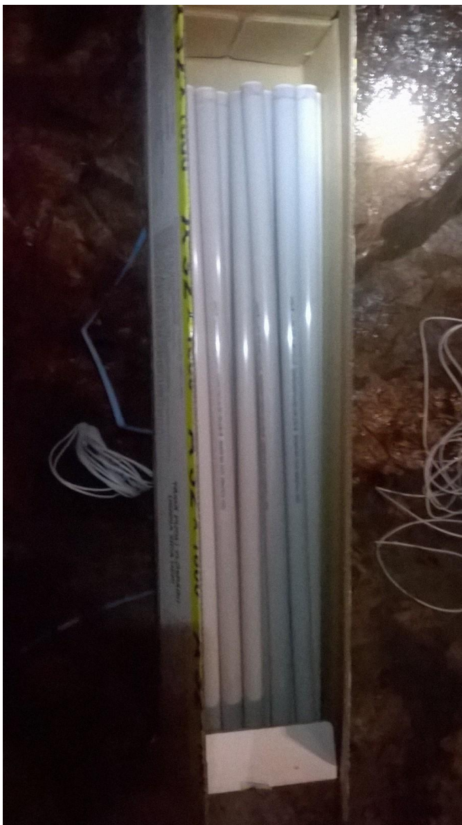
Kuva 20: Kemix A -putkipanoksia tunnelissa.
