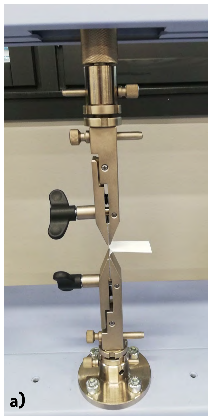
Kuva 2. (a) Kuumasaumatun näytteen lujuusmittaus (b) Sauman lujuus eri saumauslämpötiloissa. (Kuvat: Mahdi Merabtene)
